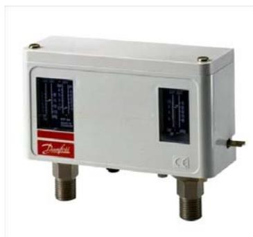
Сдвоенное реле давления КР 44 предназначено для управления и защиты водяных насосов. КР 44 комбинирует функции выключателя давления и контролирующего устройства. Левый сильфон контролирует давление в системе. Правый - выключает насос, если давление всасывания насоса слишком низко. Таким образом насос защищен от повреждений, связанных с сухим ходом.
