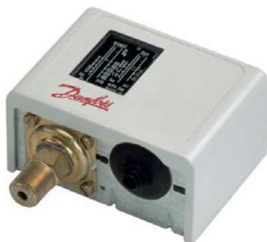
Реле давления типа КР/КРІ предназначены для регулирования, текущего контроля и аварийной сигнализации в промышленности. Устанавливаются в системах с жидкими и газообразными средами. Реле давления снабжены однополюсными выключателями, которые замыкают или размыкают электрическую цепь при изменении давления в системе по сравнению с заданным.
