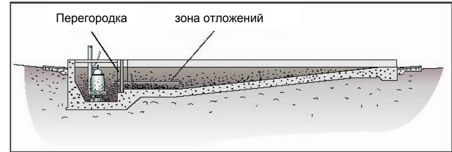
Отстойники меньшего объема с откосными стенами создают турбулентность и высокую скорость в отстойнике, предотвращая осаждение шлама. Осевшие твердые частицы соскальзывают в зону непосредственно под впуском насоса.
