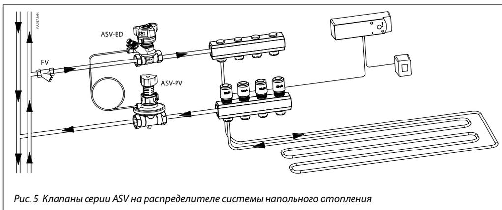
Рис. 5 Клапаны серии ASV на распределителе системы напольного отопления
