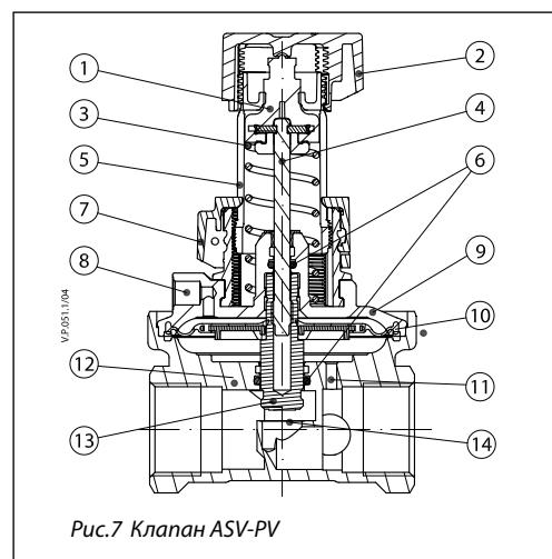
Рис.7 Клапан ASV-PV
