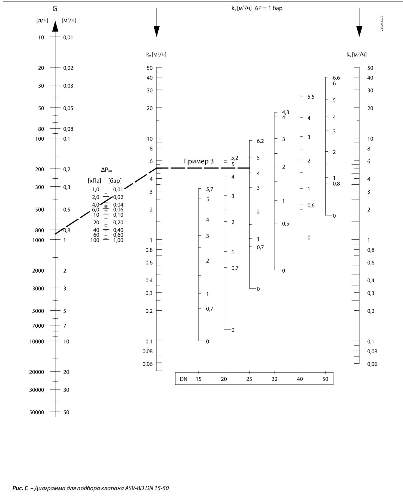
**Рис. С - Диаграмма для подбора клапана ASV-BD DN 15-50**
