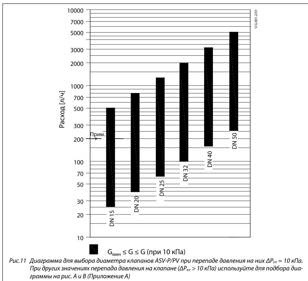
Выбор диаметра клапана ASV-P/PV при потере давления на нём 0,1 бар рекомендуем производить с помощью диаграммы (рис. 11). После выбора диаметра клапана ASV-P/PV необходимо также определить диаметр клапанов-партнёров ASV-BD, ASV-M или ASV-I по соответствующим диаграммам.
