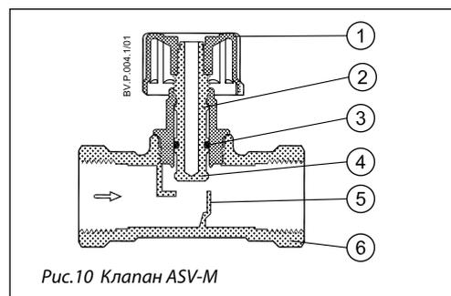
Рис.10 Клапан ASV-M
