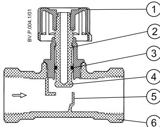
Рис.10 Клапан ASV-M
