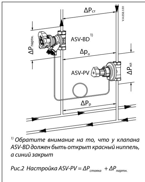
Клапан ASV-BD может быть внесён внутрь регулируемого участка или вынесен за его пределы. Это зависит от того, какой из измерительных ниппелей (красный или синий) оставить в открытом положении. Для использования клапана ASV-BD вне пределов регулируемого участка в открытом положении должен быть синий ниппель (открыт при поставке с завода-изготовителя). При необходимости использования клапана ASV-BD внутри регулируемого участка необходимо открыть красный ниппель и перекрыть синий.
