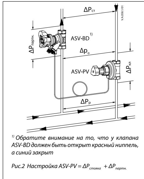
Клапан ASV-BD может быть внесён внутрь регулируемого участка или вынесен за его пределы. Это зависит от того, какой из измерительных ниппелей (красный или синий) оставить в открытом положении. Для использования клапана ASV-BD вне пределов регулируемого участка в открытом положении должен быть синий ниппель (открыт при поставке с завода-изготовителя). При необходимости использования клапана ASV-BD внутри регулируемого участка необходимо открыть красный ниппель и перекрыть синий.
