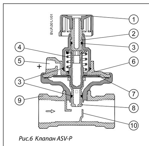
Рис.6 Клапан ASV-P
