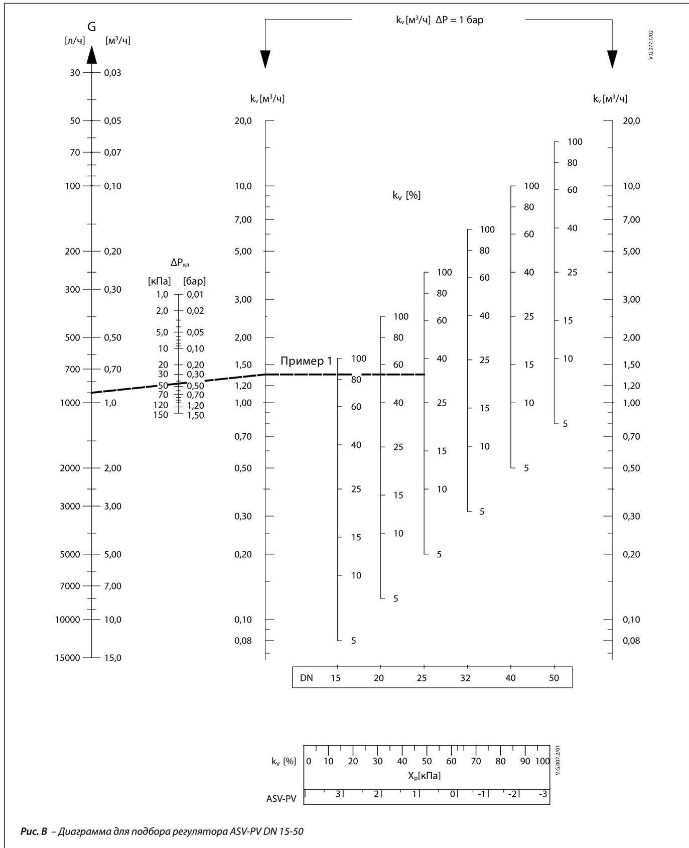
Рис. В – Диаграмма для подбора регулятора ASV-PV DN 15-50
