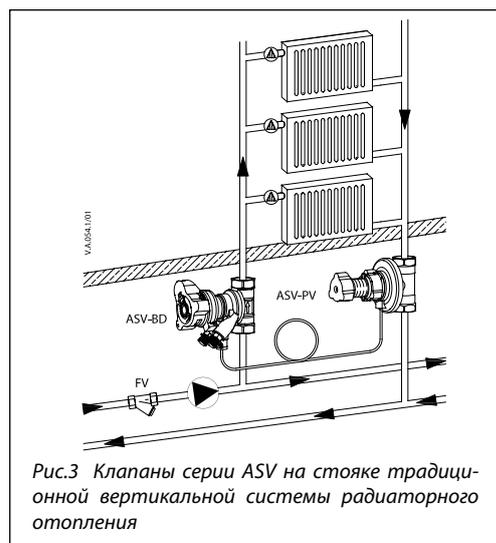
Рис.3 Клапаны серии ASV на стояке традиционной вертикальной системы радиаторного отопления
