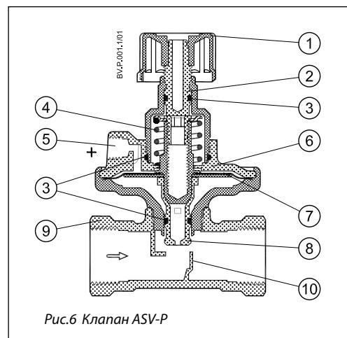
Рис.6 Клапан ASV-P
