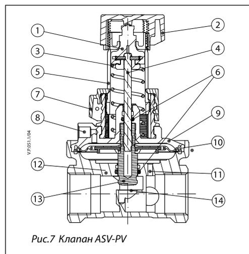
Рис.7 Клапан ASV-PV
