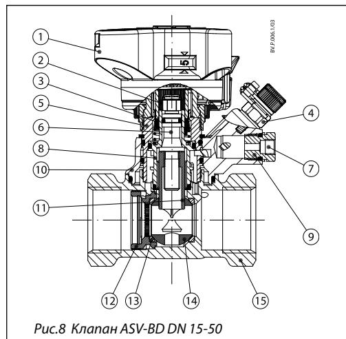
Рис.8 Клапан ASV-BD DN 15-50
