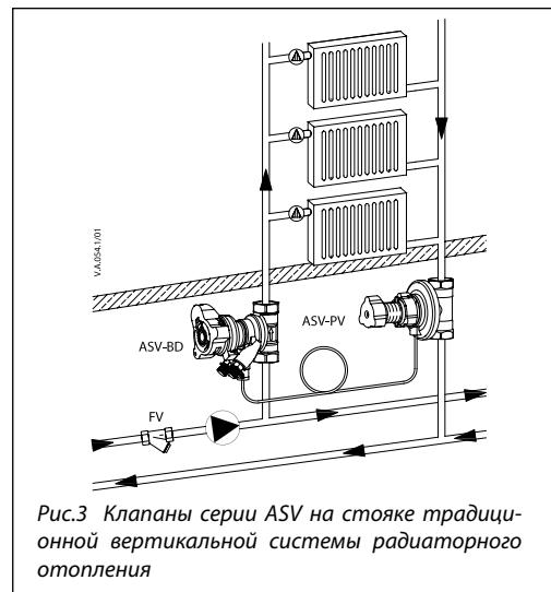
Рис.3 Клапаны серии ASV на стояке традиционной вертикальной системы радиаторного отопления
