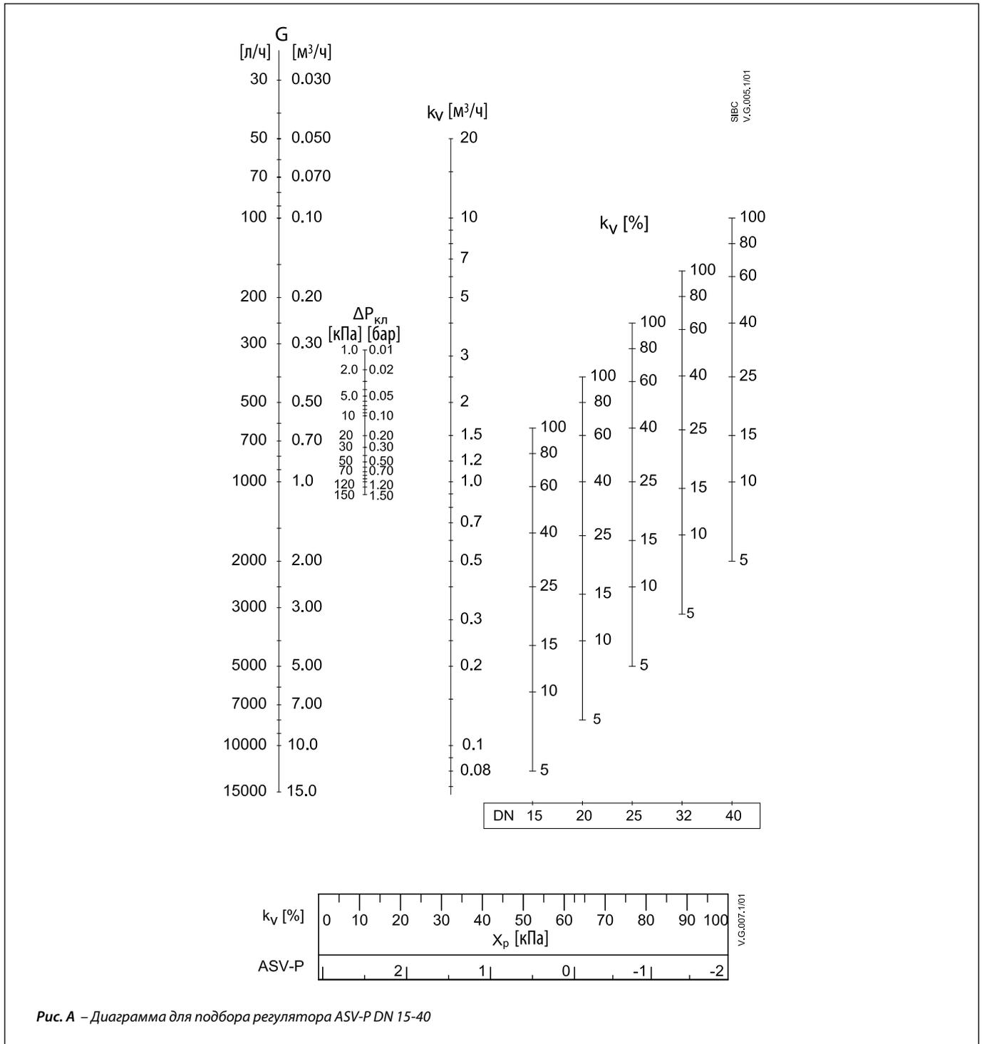
Рис. А – Диаграмма для подбора регулятора ASV-P DN 15-40
