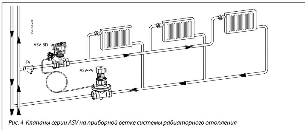
Рис. 4 Клапаны серии ASV на приборной ветке системы радиаторного отопления
